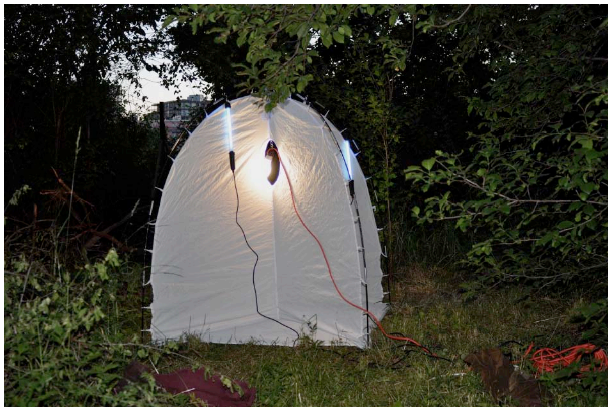
Obr. 5 Plátno se samonosnou konstrukcí a dvě trubice BL TL 8W/10 G5 Actinic Philips.
